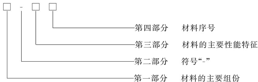
4.1.1 型号的第一部分:一元、二元系统用化学元素的缩写符号代表材料的主要组份;三元系统第一、二组份以化学元素的缩写符号代表材料的主要组份,其他组份用化学元素符号表示,如表 1 所规定。
