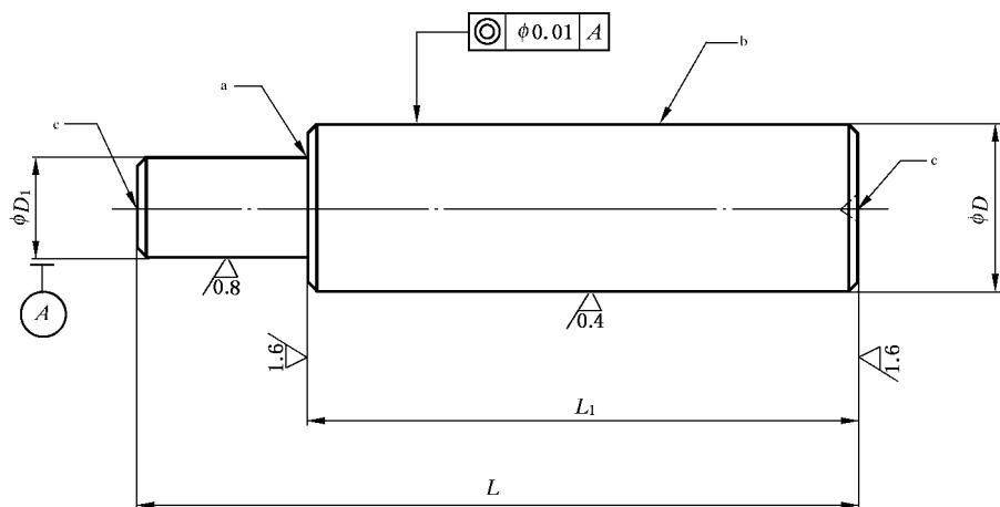
未注表面粗糙度  $R_a=6.3 \mu\text{m}$ ；未注倒角  $1 \text{ mm} \times 45^\circ$ 。
