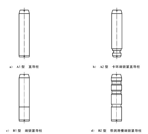
图 1 导柱结构型式
