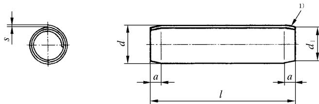
1) 两端挤压倒角。
